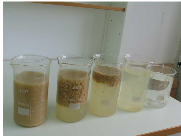
Сточные воды после прохождения этапов очистки
